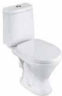
Унитаз-компакт Артикул 1.P210.3.S00.00B.F Комплектация комфорт: бачок с механизмом двухрежимного слива, чаша с горизонтальным выпуском, сиденье с крышкой из полипропилена
